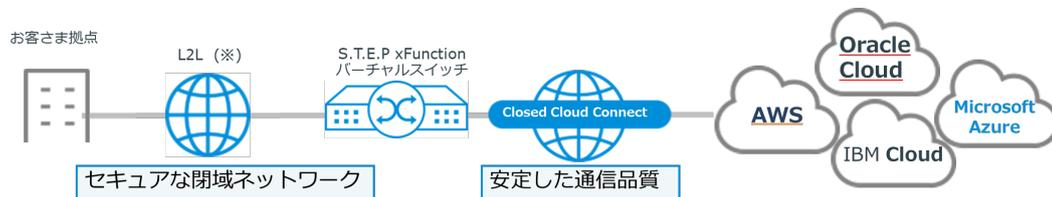
S.T.E.P xFunction Closed Cloud Connectによって、閉域ネットワークでメガクラウドまで接続するため、外部からのセキュリティリスクなく、安定した通信品質で、お客さま拠点とメガクラウドを接続することが可能となります。
