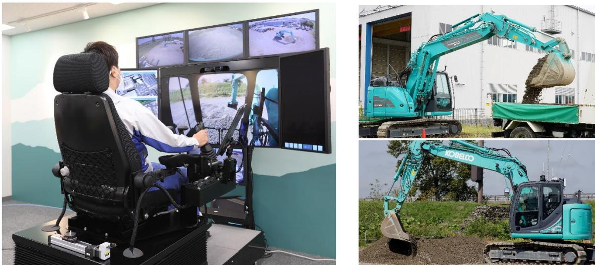
実証実験の様子 (左：札幌での操作の様子、右：帯広/広島での遠隔稼働の様子)
